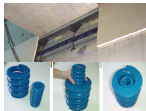
The « tuning » spring (18,5kN) can be placed into the « structural » spring (73,6kN)
